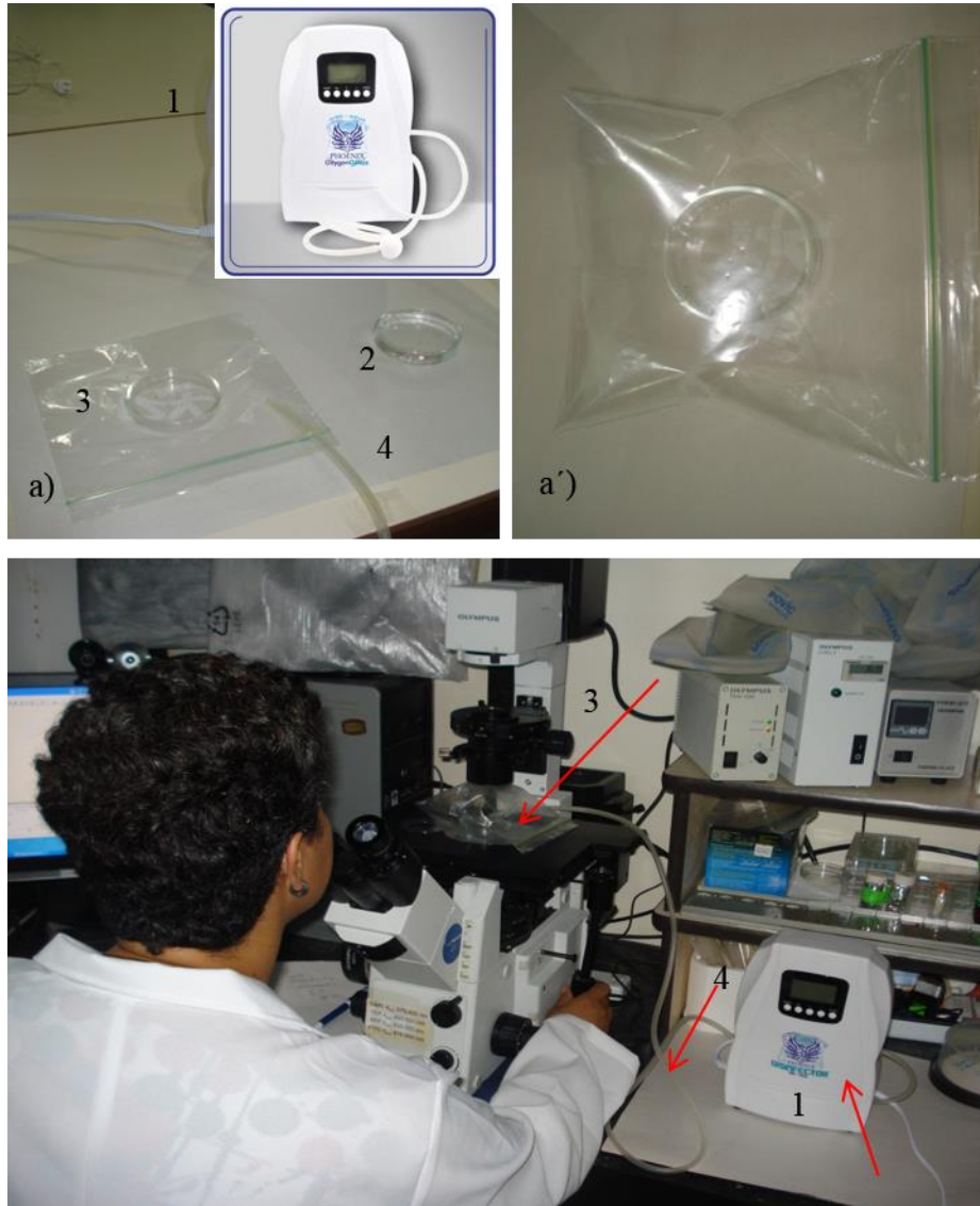
Fig.1. La figura representa el diseño de experimental para la ozonización in vivo sobre modelo larvario de pez cebra Danio rerio . a) Fuente de ozonización, OxigenYPlus Desinfector. Capsula de Petri con población larvaria de Pez cebra (2). Bolsa de polietileno 8x12 cm (3). Manguera dispensadora (4). A mayor aumento (a'), se destaca la capsula contentiva de las larvas en el ambiente ozonizado. Por último, observación al microscopio Olympus TX71 invertido, para registro fotográfico y observación morfológica.
